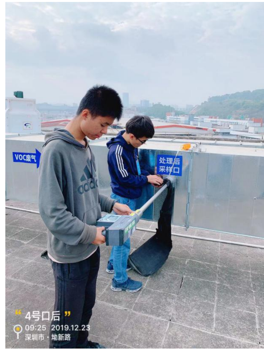
3#1 楼印刷废气处理后检测口
